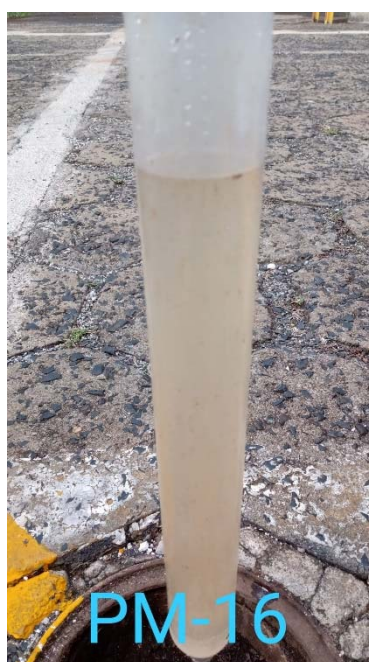
Foto 03: Visualização dos trabalhos de monitoramento in situ com a presença de película oleosa (<0,5 cm) no poço PM-16, em outubro de 2021.
